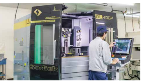
●ワイヤー放電加工機 (Sodick AL400P)
